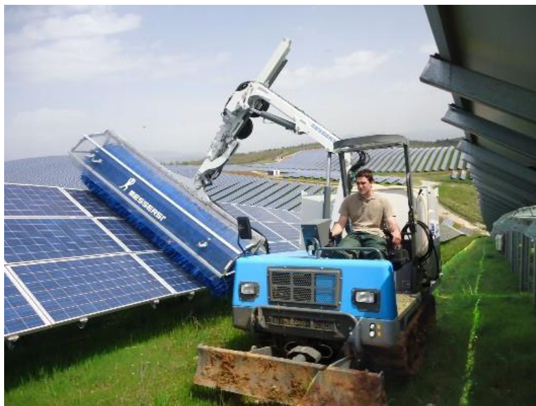
Fotografia 4.19 – Exemplo do equipamento para limpeza dos painéis fotovoltaicos
